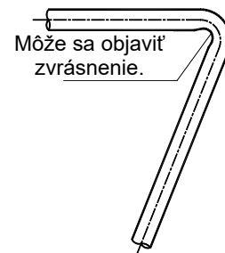
Obrázok 3-3.4: Ohýbanie potrubia v uhle väčšom ako 90^\circ
