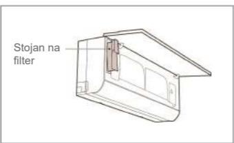
4. Znovu vložte filter a upravte polohu panela pred zapnutím napájania
