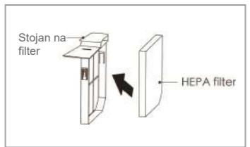
3. Vytiahnite HEPA filter a stojan na filter von z klimatizácie, aby ste mohli umiestniť nový HEPA filter
