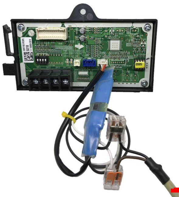
SCHÉMA PŘIPOJENÍ MOV-UU ke kompresorové jednotce UU-- + modulu KM113.27UU (obr.6) (příklad pro jednotku UU18W.UE4)
