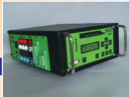
Prístroj je určený pre záznam poruchových javov - priebehu napätií, prúdov a logických signálov v elektrických distribučných sietiach NN, VN prípadne VVN. Je vhodný pre zachytenie a identifikáciu náhodných jednorázových javov, ako krátkodobé prepätie, podpätie alebo nadprúdy.
